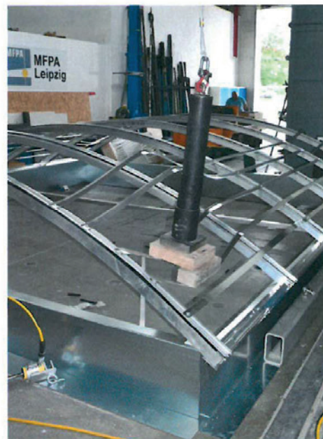
Abbildung 2: 15-minütige Belastung mit einer Personenlast in Höhe von 100 kg
