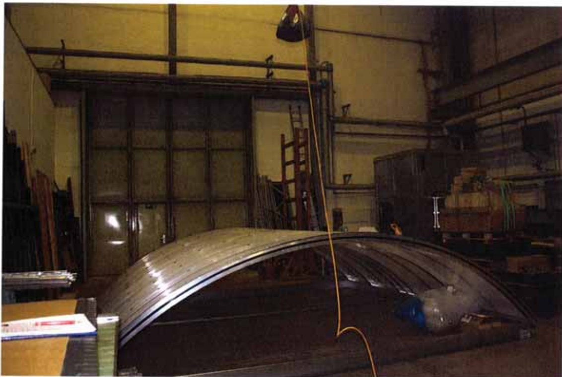
Abbildung 2: aufgebautes Dachlichtband, Breite 5,00m
